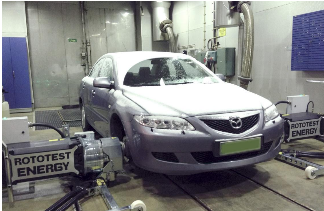
Rototest 轴耦合式测功机环境舱版本的实际交付案例
