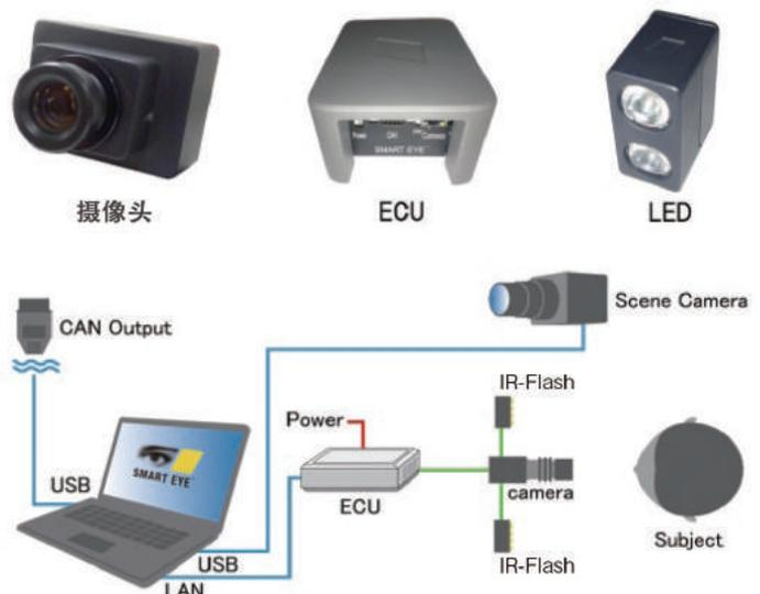
系统构成图[标准配置 + Scene Camera + CAN Output]
