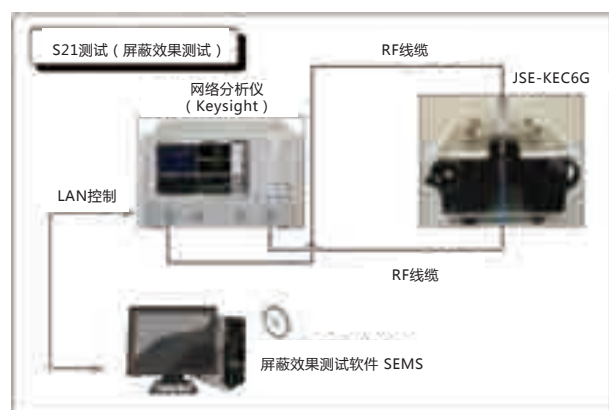
系统连接举例 使用JSE-KEC6G时 (通过损耗测试S21)
