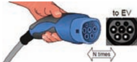
PP连接循环模拟器，用于插拔循环测试
